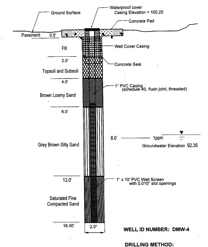
DRILLING METHOD: DIRECT PUSH PROBE
